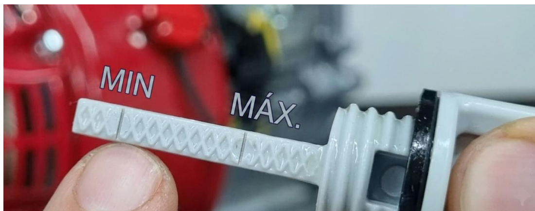
Figura 3: El nivel de aceite debe estar entre el nivel mínimo y máximo.
