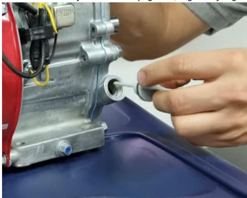
Figura 2: Verificar el nivel de aceite desenroscando el tapón en la base del motor.
