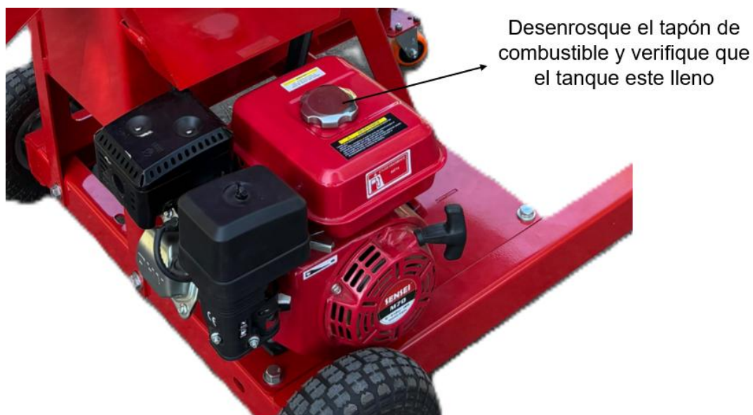
Figura 4: El nivel de combustible debe ser visible simplemente desenroscando el tapón superior.
